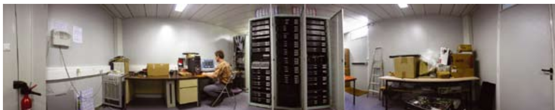
L'INSTRUMENT BON, au centre, est constitué de 64 PC biprocesseurs fonctionnant en parallèle. / The BON instrument [centre] is composed of 64 PC biprocessors operating in parallel.
